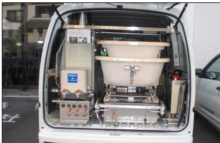
★ 搭載している入浴設備 (組立式浴槽と ボイラー・ポンプ)
